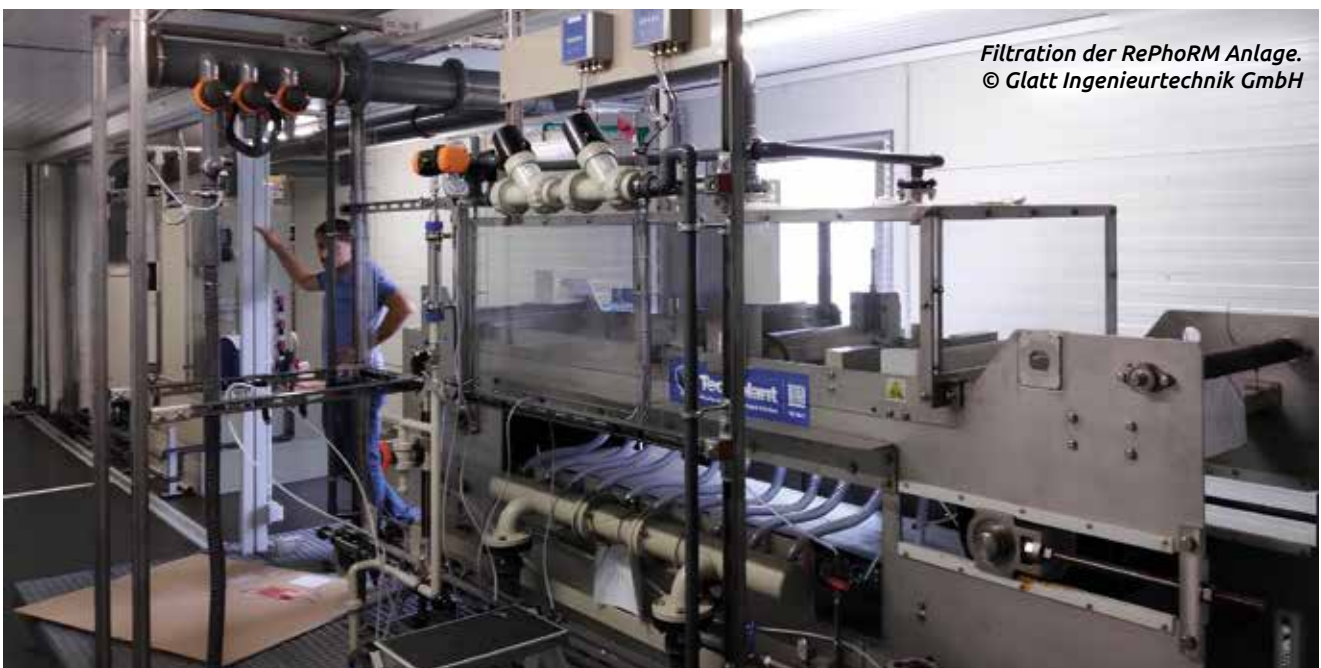
Erweitertes PHOS4green-Verfahren der P-Rückgewinnung im Projekt RePhoRM. © IWAR, TU Darmstadt
